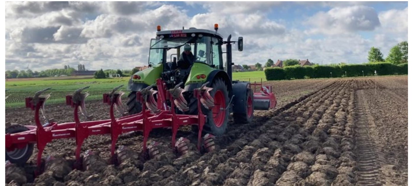
Met de ecoploeg is ondiep ploegen en bovenover rijden mogelijk
